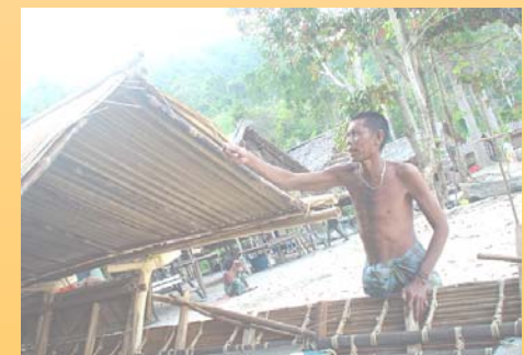
ไกวบูบอน - ทำโครงหลังคาเรือ
